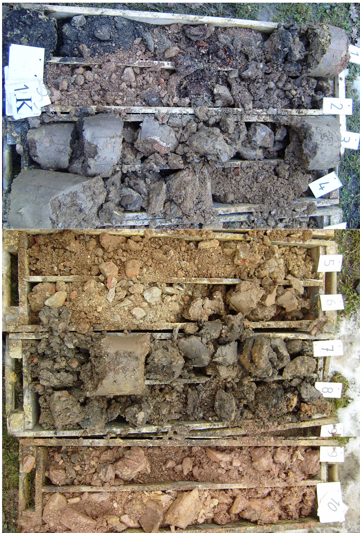
Obr. 1: Jádru průzkumné vrtu S1 (s pracovním označením K1).
