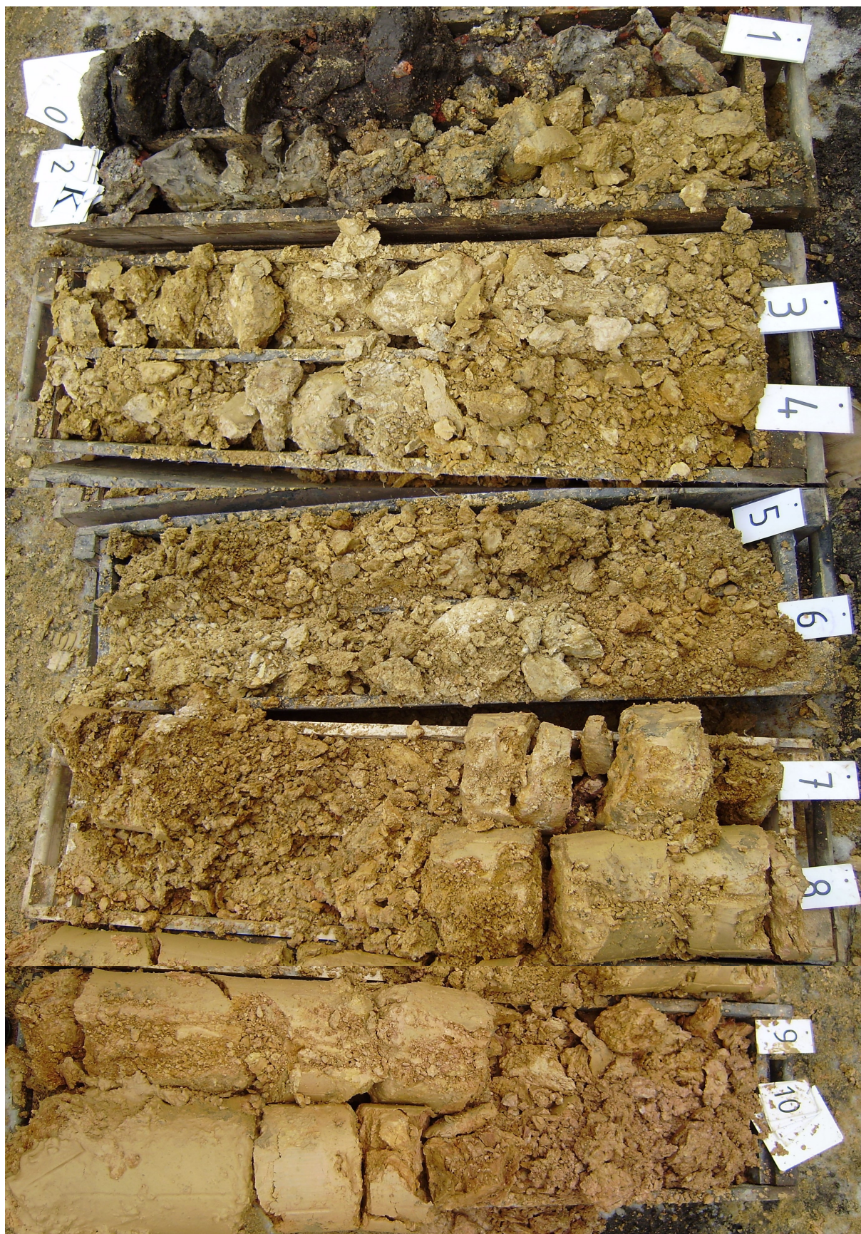
Obr. 2: Jádru průzkumné vrtu S2 (s pracovním označením K2).
