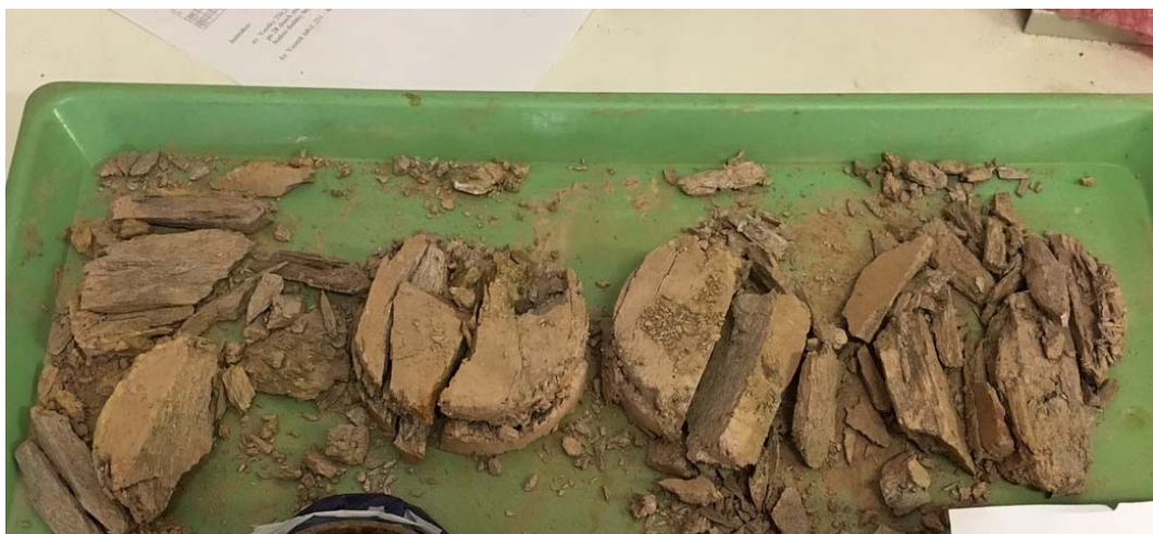
Vzorek lab.č. 247 – zkušební tělesa po smykové zkoušce
