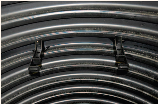
Předpříprava obruče žebříku v šachtové trubce
