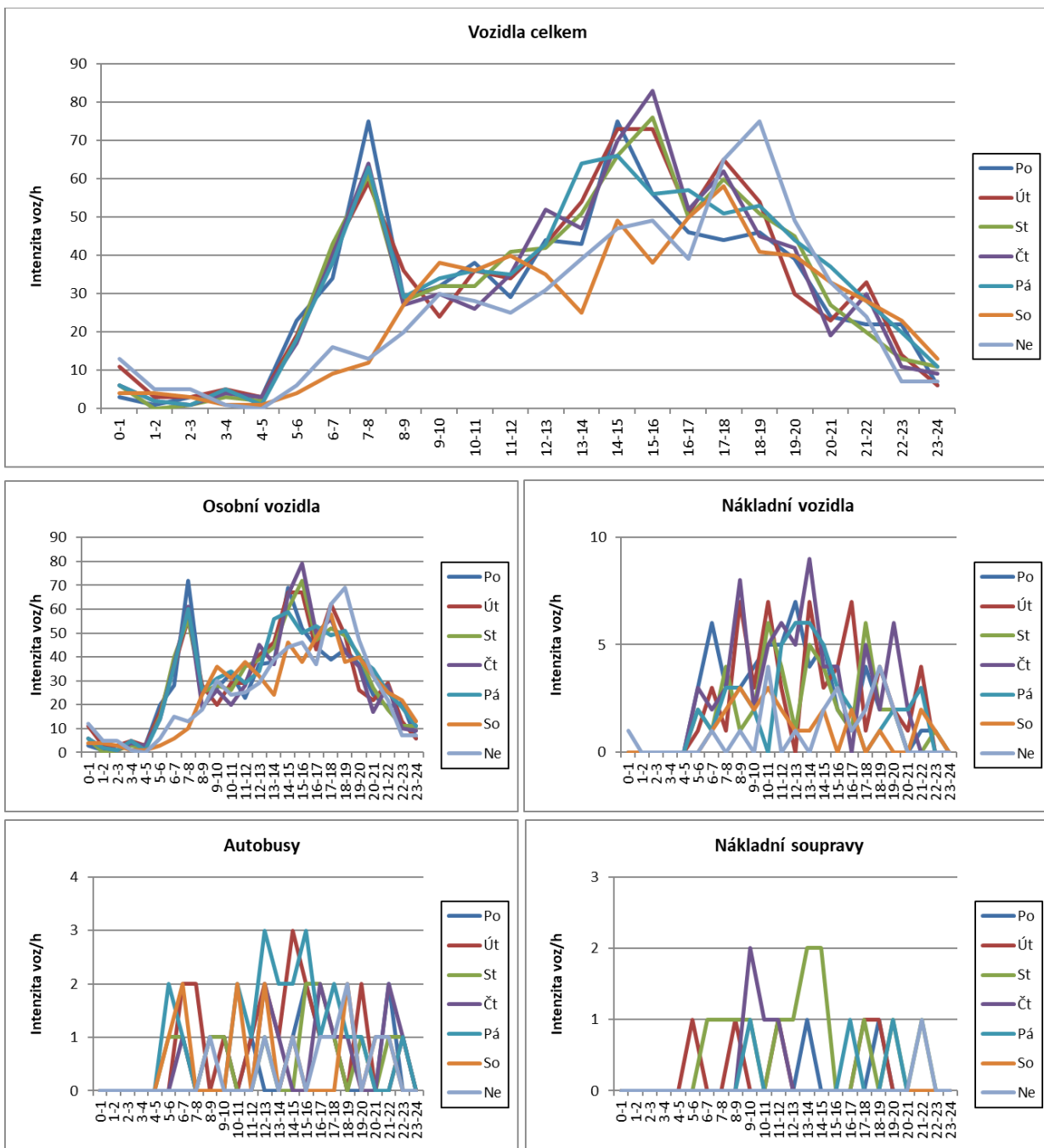
Obrázek 9: Graficky znázorněné hodinové intenzity dopravy zjištěné během průzkumu, oba směry dohromady, rozdělení dle druhů vozidel [voz/h]
