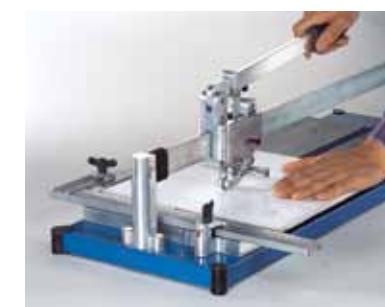
Obr. 6 – Páková ruční řezačka
